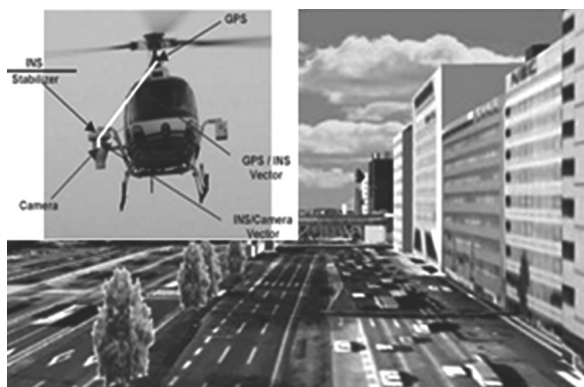
图 2 三线阵扫描系统及三维城市模型
