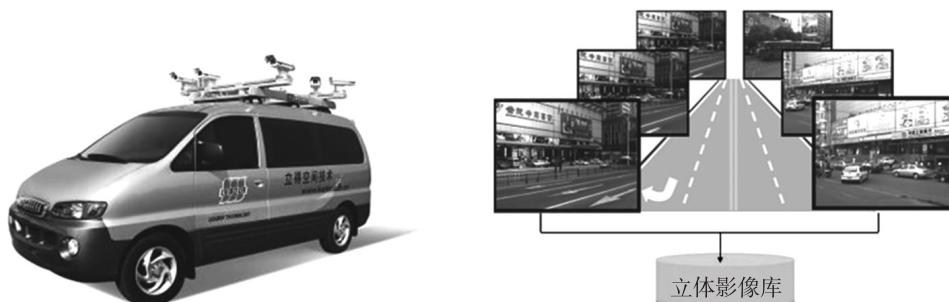
图 1 道路移动测量系统与可量测立体视频序列
