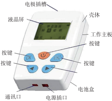
图 2 重金属检测仪的结构图 Fig. 2 Structure diagram of heavy metal detector
