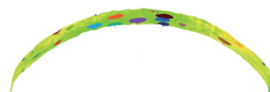
图 8 存在锚杆结构的点云簇
