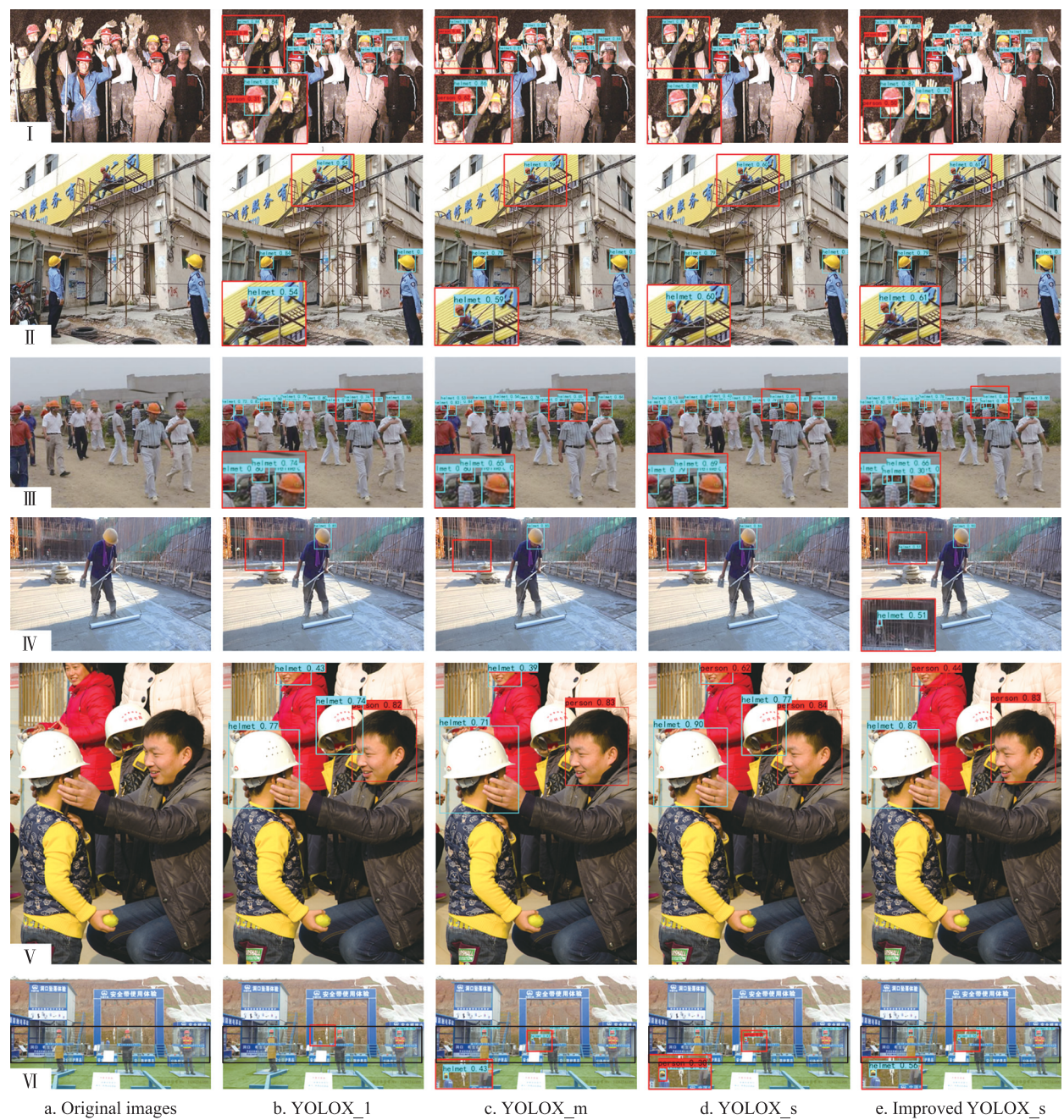
图 6 基于改进 YOLOX_s 的安全帽识别结果 Fig. 6 Helmet recognition results based on improved YOLOX_s
